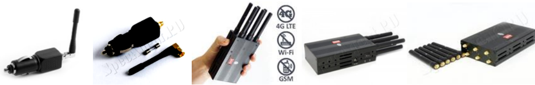
Рис. 2. Пристрої постановки радіозавад: автомобільний та кімнатний [3; 4].
