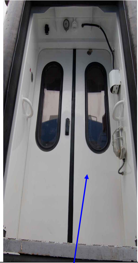
Двері для переходу між вагонами. Застосування заряду вибухових речовин для відкривання цих дверей є недоцільним
