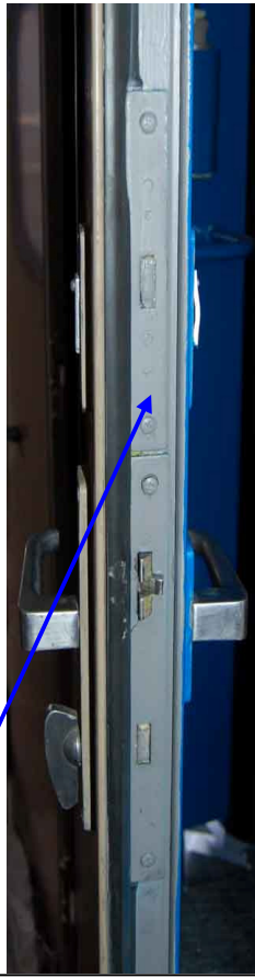
Двері для входу із тамбура в середину цільнометалевого купейного вагона (ЦМК) російського виробництва (Тверь) та влаштування дверних замків
