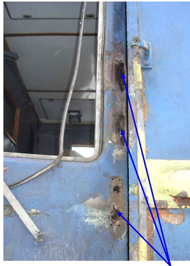
Після вибуху зарядів на вхідних дверях вагону утворилося три отвори. Ручка від дверей відлетіла на 15 м.
