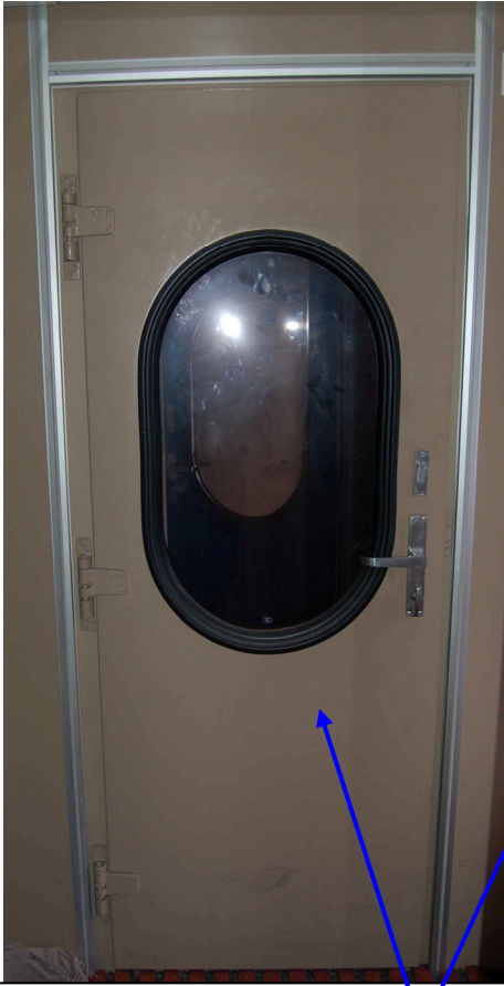
Двері для входу із тамбура в середину цільнометалевого купейного вагона (ЦМК) російського виробництва (Тверь) та влаштування дверних замків
