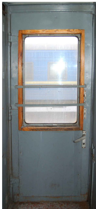
Внутрішня сторона вхідних дверей у вагон
