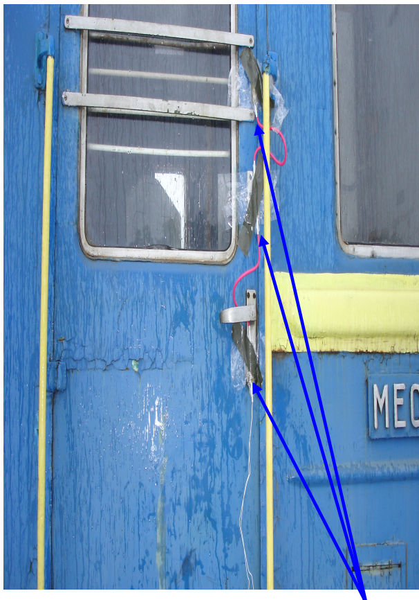
Елементи заряду КЗК-5 які закріплені на вхідних дверях за допомогою скотча
