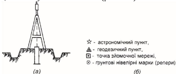
Рис. 3.6. (а) геодезичний знак (піраміда); (б) зображення пунктів на картах
