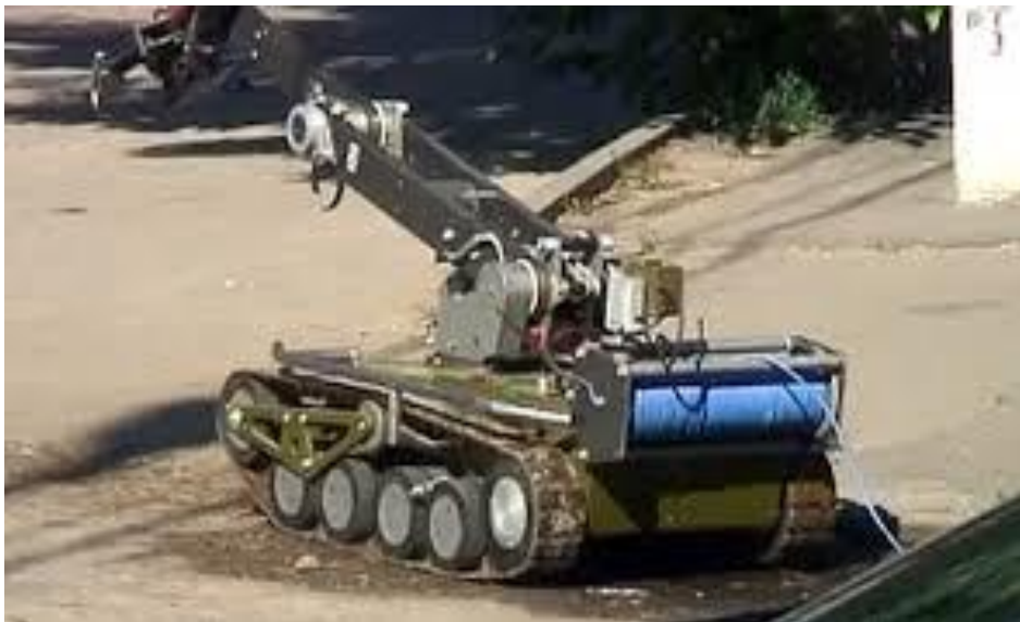
Фото 8. Спеціальна техніка для проведення робіт по знешкодженню вибухових пристороїв.
