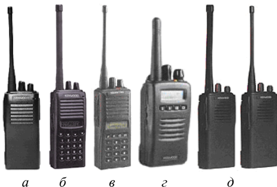
Рис. 3.10. Носимі радіостанції Kenwood: а – ТК-260G/360G, б – ТК-270G/370G, в – ТК-280/380, г – ТК-2140/3140, д – ТК-2107/3107
