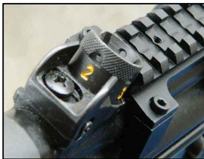
Регульований барабанний цілик і мушка у захисному кільці намушника
