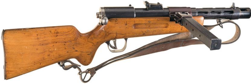
Пістолет-кулемет MP-34/1, MP-35/1 (MP скор. від нім. Maschinenpistole) модифікації пістолета-кулемета німецької фірми Bergmann Waffenfabrik, розроблених Емілем Бергманом на основі його більш ранніх проектів пістолетів-кулеметів В.М.Р.-32
