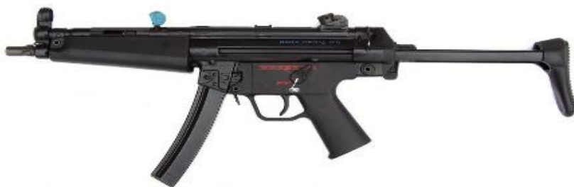
На відміну від бойового MP-5 A3, у MP-5 PT сині деталі затвору та надпис на ствольній коробці – «only plastic training»
