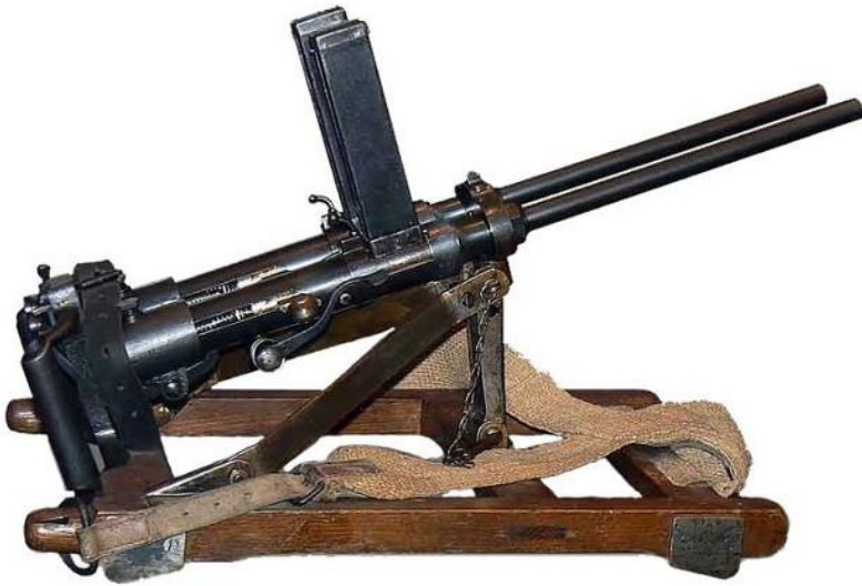
Villar-Perosa – 9-мм італійський авіаційний спарений пістолет-кулемет. Розроблений у 1914 році майором італійської армії Бетелем Абедем Ревеллі. Його модифікації застосовувалися під час Першої світової війни здебільшого в авіації
