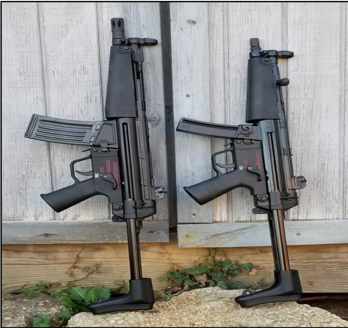
Зовнішній вигляд пістолетів-кулеметів НК 53 під 5,56 × 45 мм та MP-5 A3 під 9 × 19 мм
