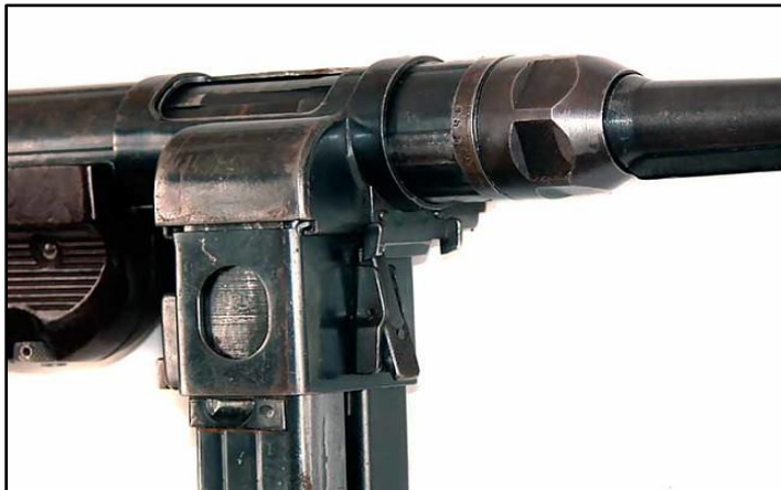
Пристрій для кріплення двох магазинів пістолета-кулемета МР-40/1
