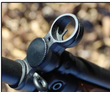
Регульований барабанний цілик і мушка у захисному кільці намушника
