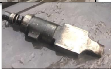
Приклад забруднених деталей затворного механізму пістолета-кулемета МР-5
