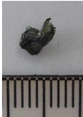
Рисунки 4,5,6,7,8 – Сторонні предмети, що можуть бути виявлені в шпарині циліндру
