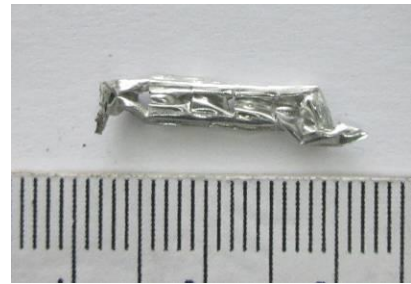
Рисунки 4,5,6,7,8 – Сторонні предмети, що можуть бути виявлені в шпарині циліндру
