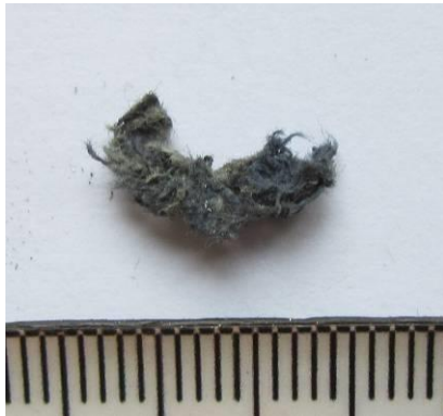
Рисунки 4,5,6,7,8 – Сторонні предмети, що можуть бути виявлені в шпарині циліндру
