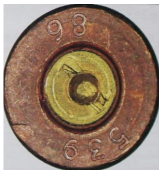
Рис. 3. Зображення слідів на слідосприймаючій поверхні гільзи, стріляної з мислив- ського карабіна «АКМ МП УОС» калібру 7,62x39 мм.
