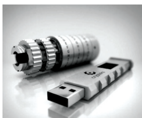
Рис. 6.26. Флешка з захистом «кріптекс» і з використанням 256-бітного AES шифрування
