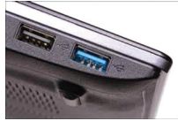
Рис. 2.3. Порти USB 2.0 (зліва) та USB 3.0 (справа)
