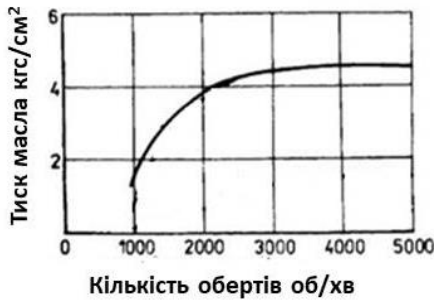
Рис. 1. Залежність тиску масла від кількості обертів колінчастого валу ДВЗ.
