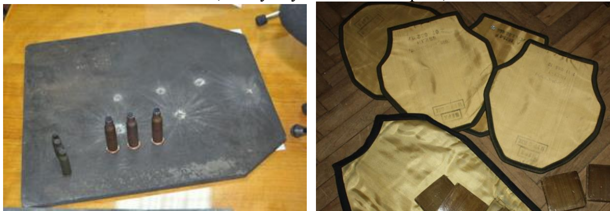
Фото 56. Елементи бронезахисту: а) бронепластина; б) кевларові «пакети» вставки.
