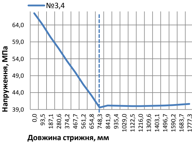
Рис. 6. Графічні залежності розподілу напружень за довжиною стрижнів консольного кронштейну: а) стрижні № 1, 2; б) стрижні № 3, 4
