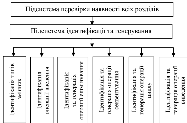
Рис. 2. Структурна схема інформаційної технології- системи генерації програм з формул теорії секвенційних алгоритмів
