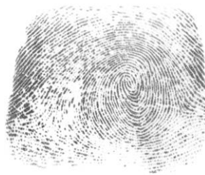
Рис. 34. Відбиток сухого пальця зі сканера без еластичного покриття призми
