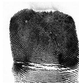
Рис. 37. Відбиток спітнілого пальця зі сканера без функції виключення вологи
