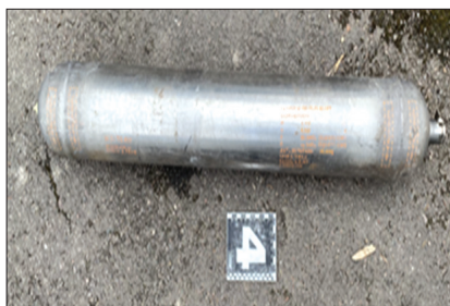
Рис. 3. Балон надування (06.0458.0090.00; 06.0458.0100.00; МР-1ГАЦ-1-24274; вага 5,935; об'єм 6,969; робочий тиск 350 атм; граничний тиск – 525 атм)
