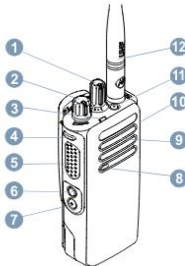
Рис. 8. Елементи керування Motorola DP4401E, де 1 – перемикач каналів, 2 – регулятор Вкл./Викл./Гучність, 3 – світлодіодний індикатор, 4 – програмована кнопка 1, 5 – тангента (Кнопка PTT (Push-To-Talk)), 6 – програмована кнопка 2, 7 – програмована кнопка 3, 8 – мікрофон, 9 – гучномовець, 10 – універсальний роз’єм для підключення гарнітури, 11 - кнопка екстреного виклику, 12 – антена.
