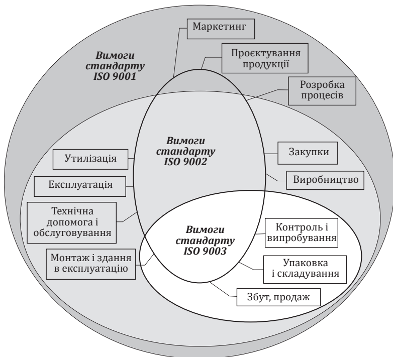
Рис. 4.2. Стадії витка якості, що охоплюються системами якості за стандартами ISO 9001, ISO 9002 та ISO 9003
