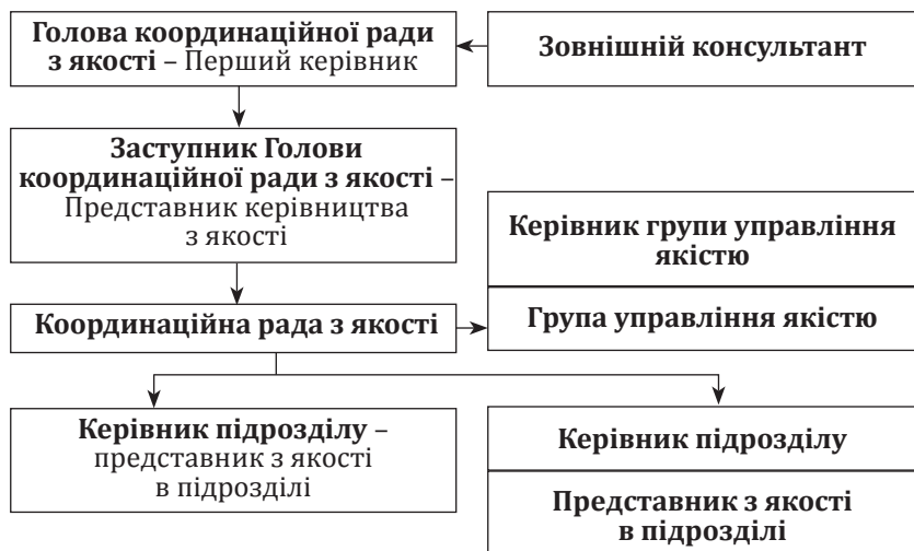
Рис. 1.3. Схема організаційної структури розробки, впровадження і супроводження СУЯ [14]
