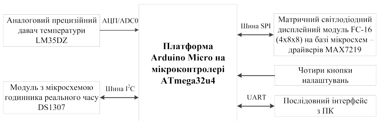
Рис.3.44. Структура цифрового годинника – термометра
