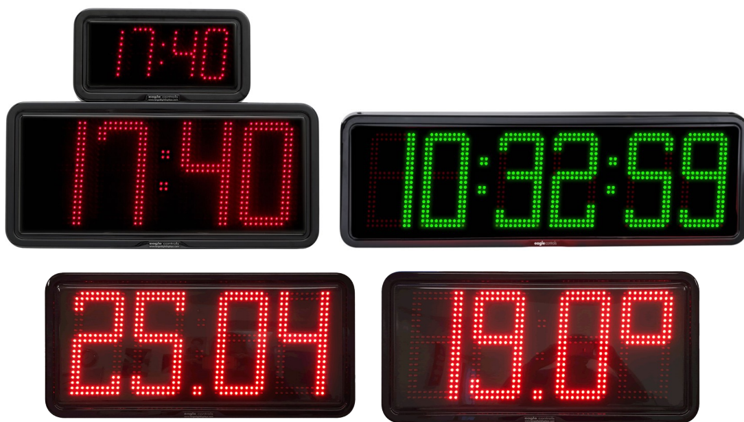
Рис.1.1. LED цифровий годинник термометр фірми eagle controls. Формати часу HRS:MINS або HRS:MINS:SECS. Діапазон вимірювання температури (прграмований): -50 ~ 99,9 °C або -58 ~ 212 °F. Формат дати: DAY/MONTH/YEAR
