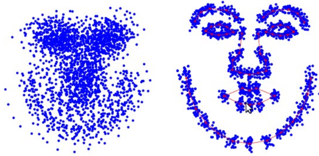
Рис.3.7. Координати точок форми обличчя до та після нормалізації
