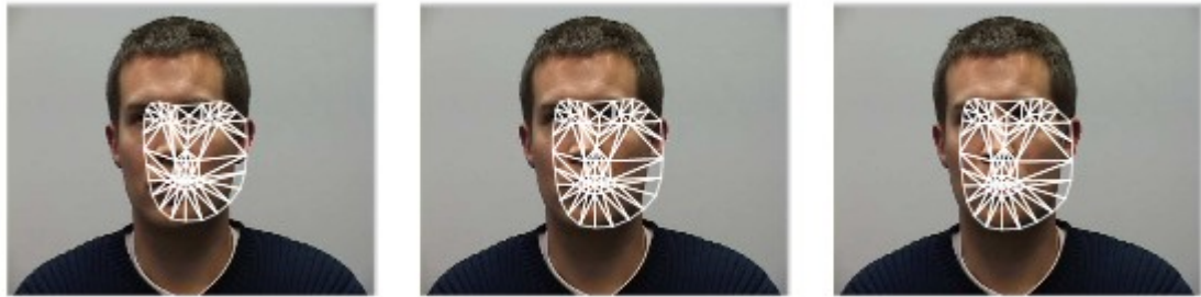
Рис.3.9. Процес підгонки моделі за допомогою градієнтного спуску
