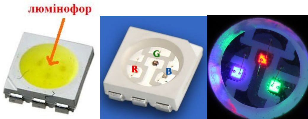
Рис. 1.5. Типи SMD світлодіодів (білий SMD 3528 і RGB SMD5050)
