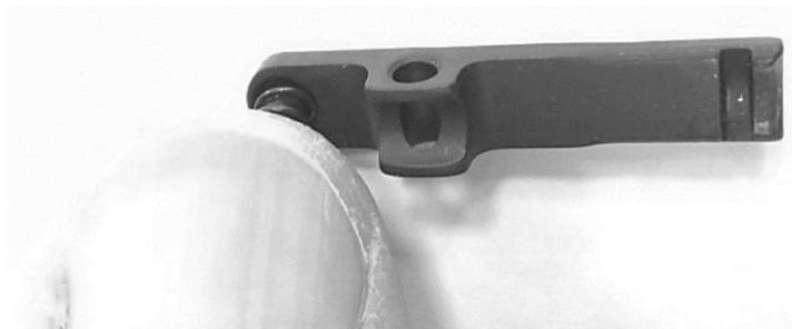
Мал. 110. Утримання пружини викидача при її знятті або встановленні.
