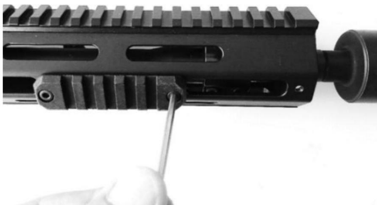
Мал. 120. Кріплення планки «пікатіні» на цівку з різьбовим кріпленням планок.
