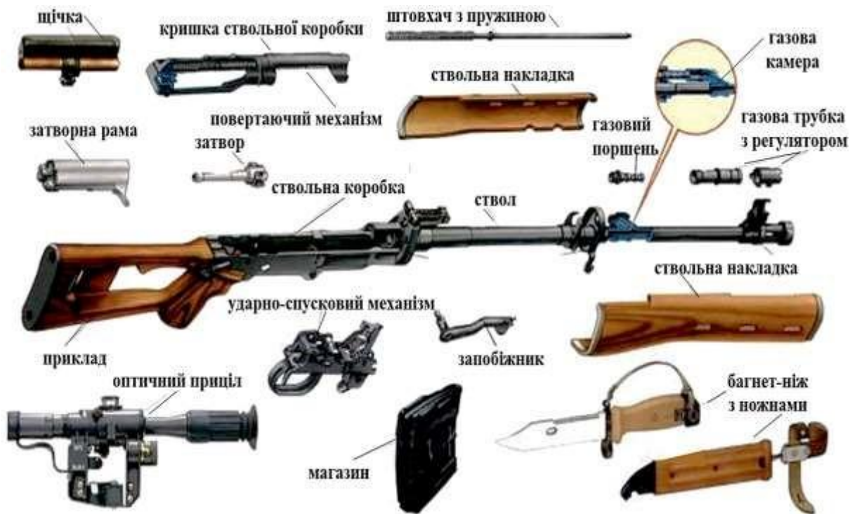
Рис. 47. Основні частини і механізми снайперської гвинтівки Драгунова
