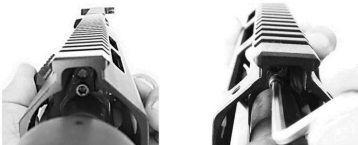
Мал. 123. Регулювання газблоку.
