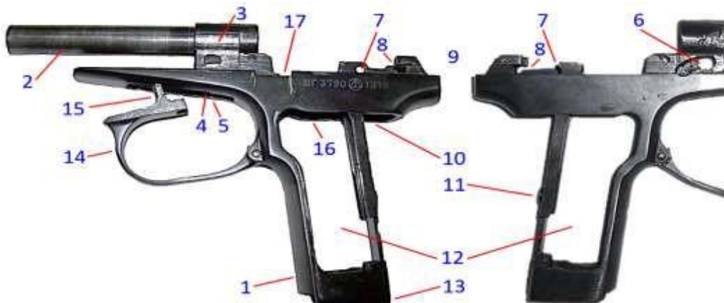
Рис. 62. Рамка зі стволом і спусковою скобою:
