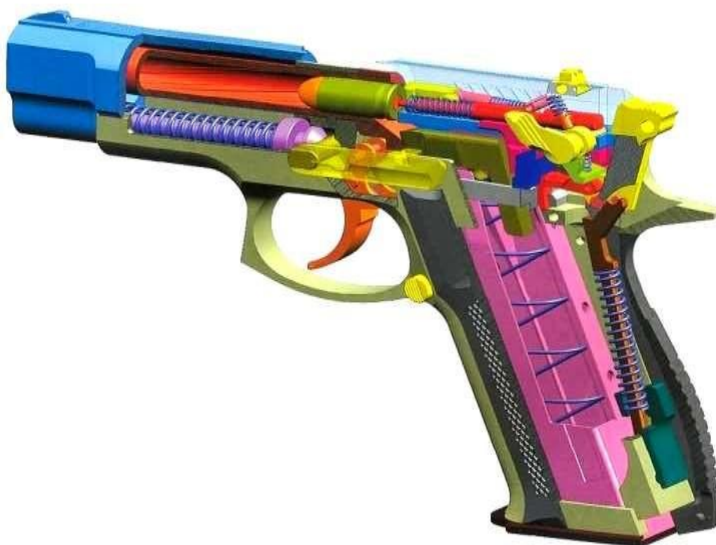
Рис. 95. 9 мм пістолет «Форт-12» в розрізі
