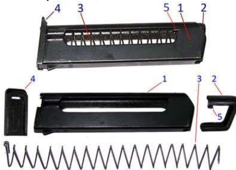
Рис. 76. Магазин пістолета і його складові частини: 1 – корпус магазину; 2 – подавач; 3 – пружина подавача; 4 – кришка магазину; 5 – зуб подавача
