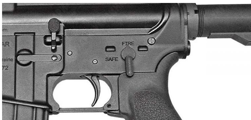
Мал. 100. Запобіжник у положенні «FIRE».
