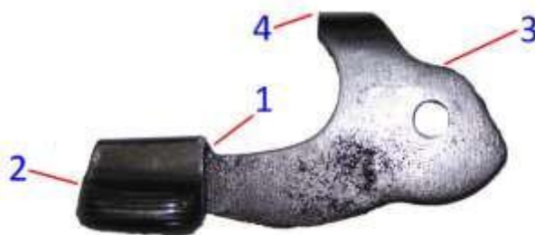
Рис. 74. Затворна затримка: 1 – виступ; 2 – кнопка з насічкою; 3 – гребінь; 4 – відбивач
