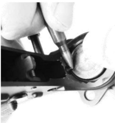
Мал. 87. Від’єднання буфера віддачі та зворотної пружини.
