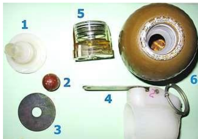
Рис. 113. Частини розібраного запалу УДЗ і корпус бойової частини гранати: 1 – трубка детонаційної шашки; 2 – інерційна кулька; 3 – мембрана; 4 – запобіжно-накольний механізм із спусковим важелем; 5 – ударний датчик; 6 – корпус гранати РГО
