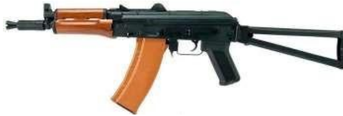
Рис. 8. АКС-74У з металевим прикладом, який складається
