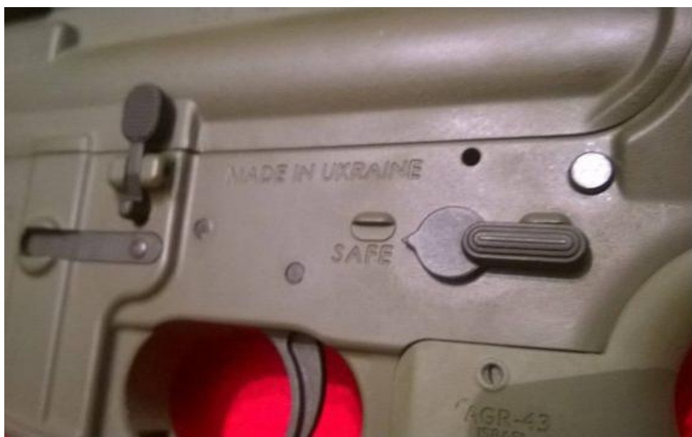
Мал. 98. Запобіжник у положенні «SAFE».
