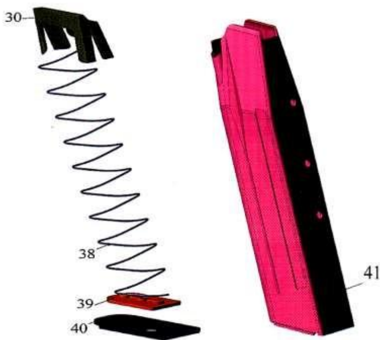
Рис. 93. Подавач з пружиною і корпус магазину. 30 – подавач; 38 – пружина магазину; 39 – дно магазину; 40 – кришка магазину; 41 – корпус магазину
