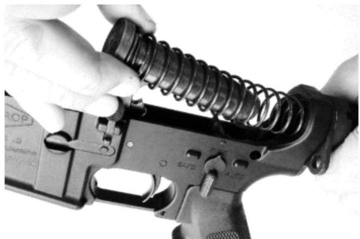
Мал. 87. Від’єднання буфера віддачі та зворотної пружини.
