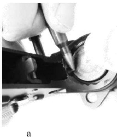
Мал. 87. Від'єднання буфера віддачі та зворотної пружини.
