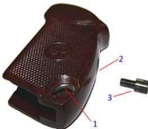
Рис. 75. Рукоятка з гвинтом: 1 – антабка; 2 – отвір; 3 – гвинт
