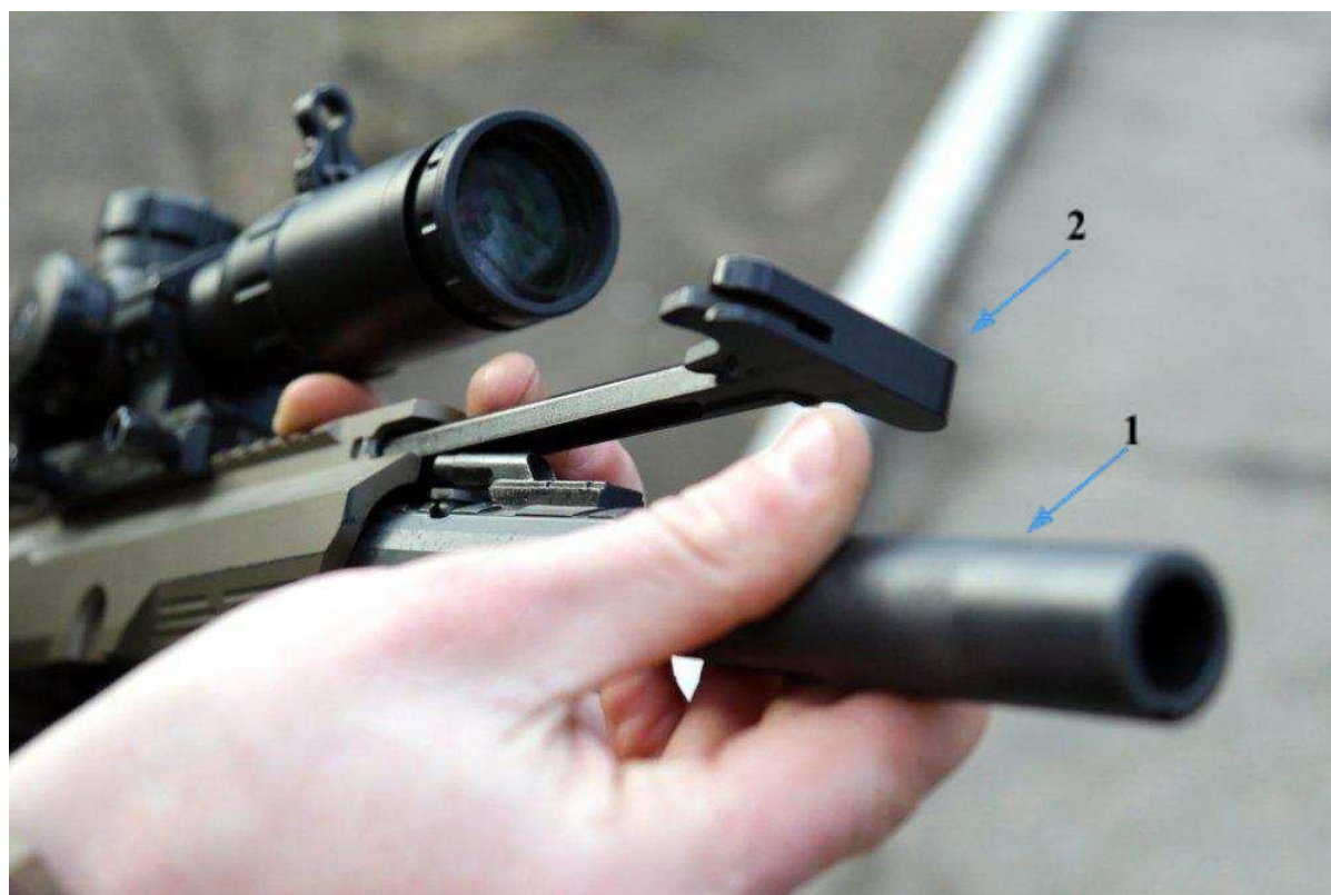
Мал. 84. Від'єднання затворної рами із затвором від корпусу гвинтівки.
