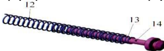
Рис. 88. Направляюча вісь з повертаючими пружинами:
