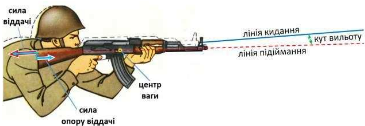
Рис. 120. Підкидання дульної частини ствола вгору при пострілі в результаті дії віддачі, утворення кута вильоту
