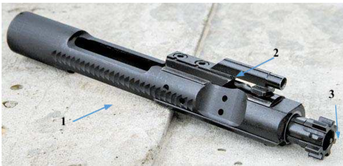
Мал. 83. Зовнішній вигляд затворної рами автоматичної гвинтівки із голівкою затвора у зборі:
