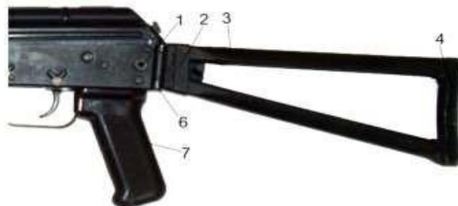
Рис. 18. Приклад (відкинуте положення) і пістолетна рукоятка: 1 – фіксатор; 2 – обойма; 3 – верхня тяга; 4 – затильник; 6 – вісь; 7 – пістолетна рукоятка
