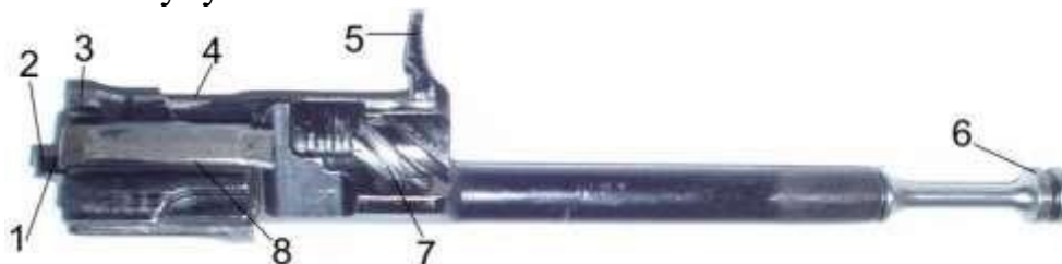
Рис. 22. Затворна рама з газовим поршнем:
