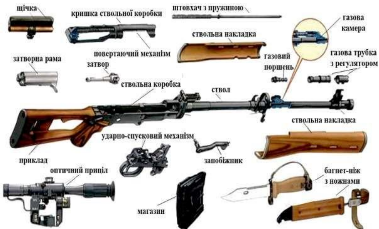
Рис. 47. Основні частини і механізми снайперської гвинтівки Драгунова
