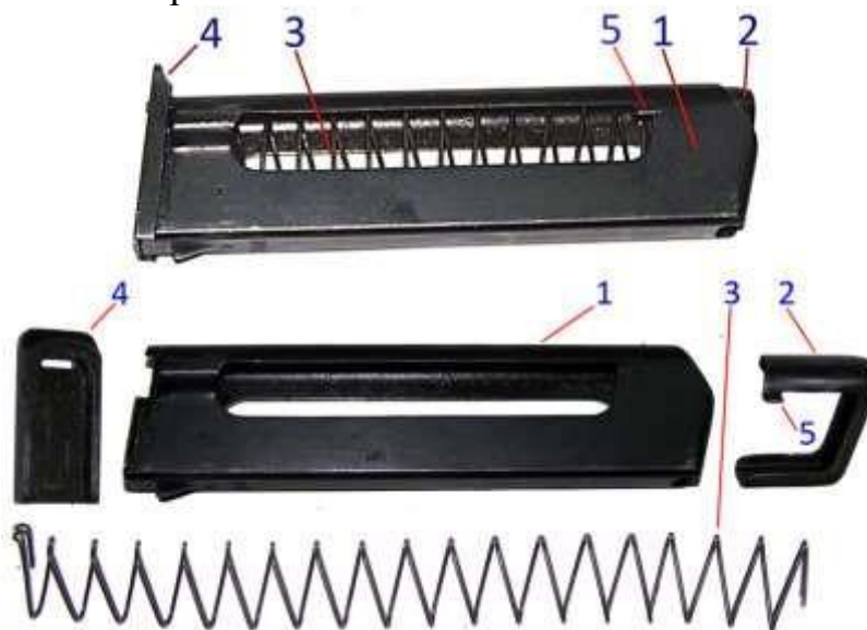
Рис. 76. Магазин пістолета і його складові частини: 1 – корпус магазина; 2 – подавач; 3 – пружина подавача; 4 – кришка магазина; 5 – зуб подавача
