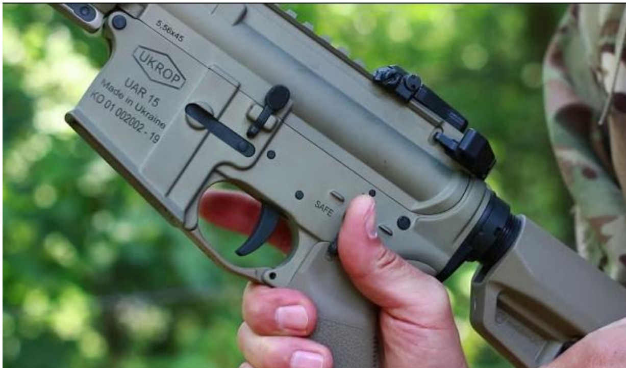
Мал. 72. Приклад маркування автоматичної гвинтівки.
