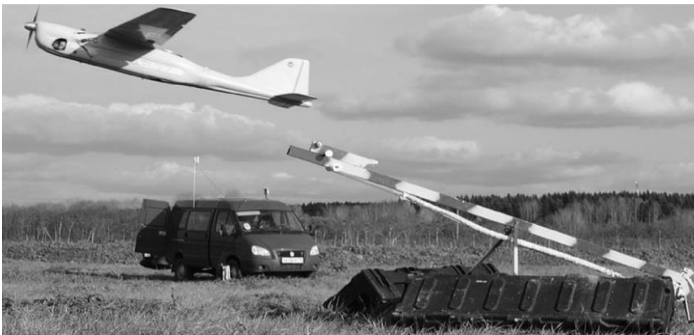
Рис. 4. Запуск розвідувального фюзеляжного БПЛА «Орлан-10» з катапульты
