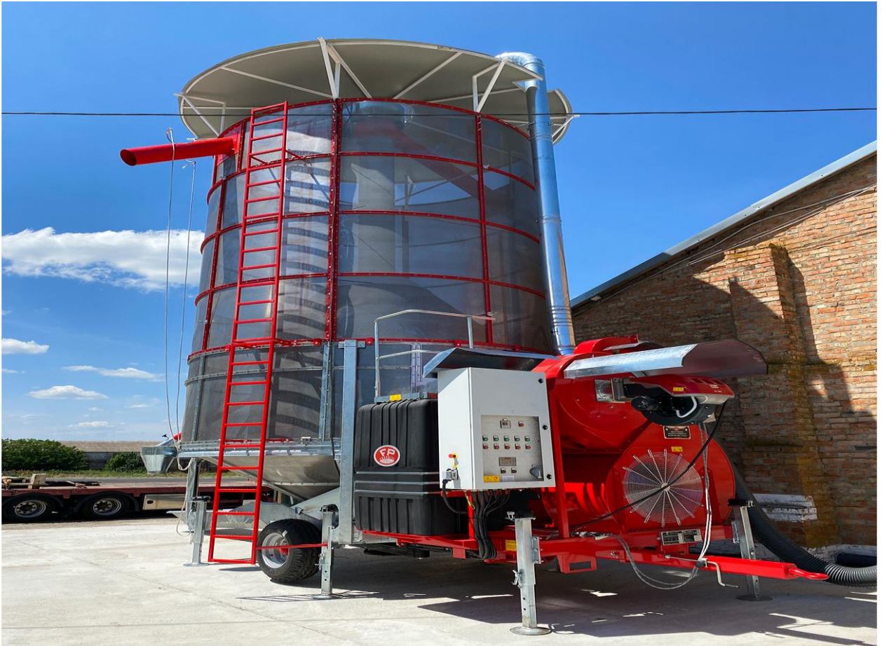
Рис. 2.3. Мобільна зерносушарка Fratelli Pedrotti XL 350 ТОВ «Фенікс Агро Трейд» [17]
