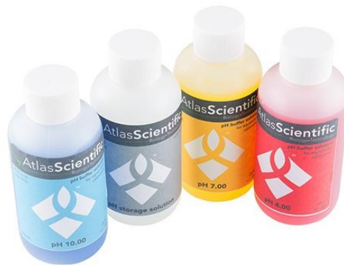
Рис. 3.15. Тестовий набір розчинів для калібрування сенсора рН SEN0161
