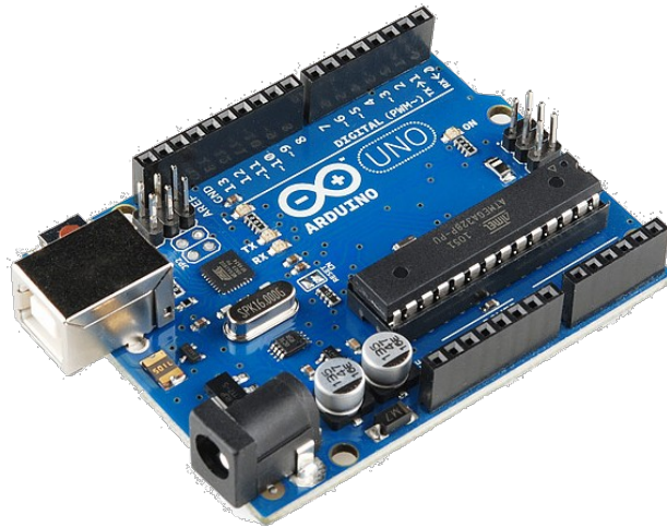
Рис. 2.2. Апаратна платформа Arduino UNO
