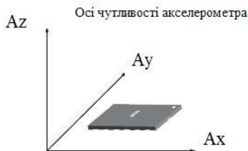
Рис. 1.9. Осі чутливості ADXL345 акселерометра
