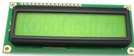
Рис. 3.12. Символьний РКД 16x2. Модель: WH1602B-YGK-СТК
