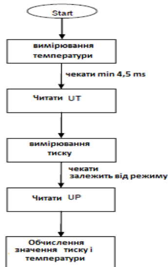
Рис. 1.11. Алгоритм вимірювання тиску сенсором BMP180
