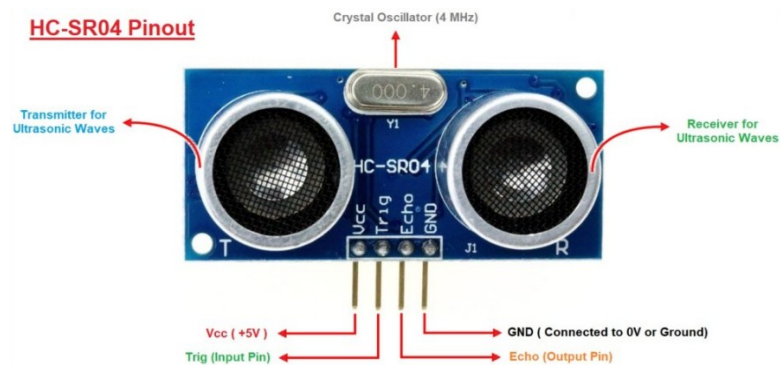
Рис. 3.14. Конфігурація та функціональне призначення виводів ультразвукового модуля HC-SR04
