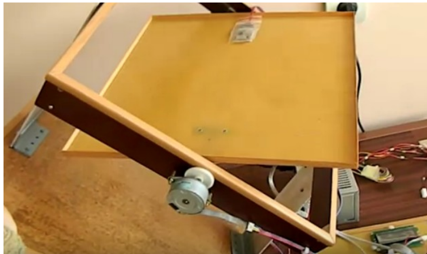
Рис. 1.2. Макетний зразок системи стабілізації для проведення експериментальних досліджень
