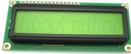
Рис. 3.11. Рідкокристалічний модуль WH1602B-YGK-CTK. Конфігурація: 2 рядки по 16 знаків, колірна схема – жовто-зелена
