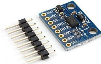
Рис. 3.15. Зовнішній вигляд сенсорного модуля на базі триосьового акселерометра ADXL345
