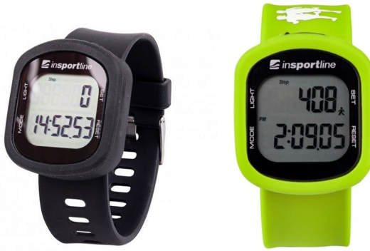
Рис. 1.2. Цифровий крокомір inSPORTline Strippy I.
