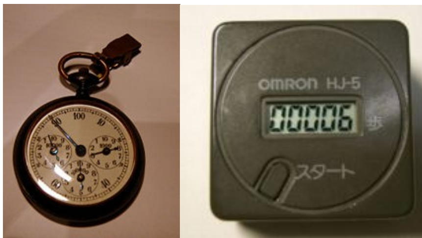
Рис. 1.3. Крокоміри (механічний (зліва) і електронний (справа))
