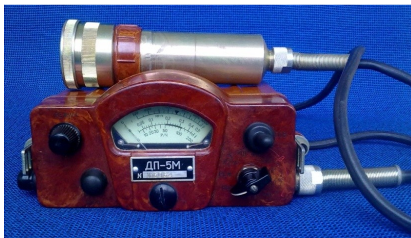
Рис. 1.5. Модифікований радіометричний пристрій ДП-5М із вбудованим слюдяним детектором
