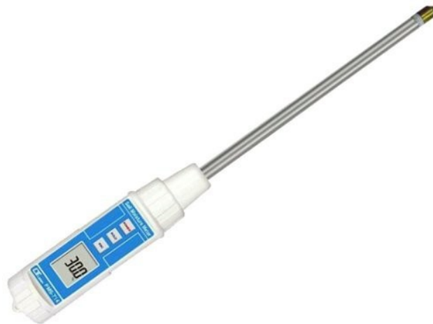
Рис. 1.5. Мікропроцесорний вологомір серії Lutron у корпусі з ABS-пластику
