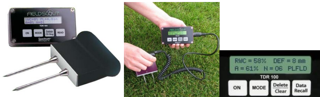
Рис. 1.6. Прецизійна вимірювальна система TDR-100 з послідовним інтерфейсом передачі даних RS-232.
