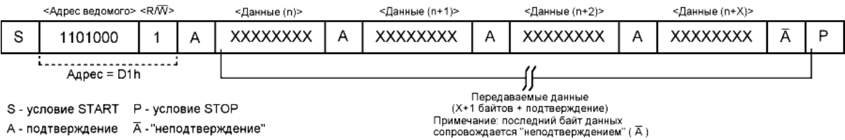
Рис. 3.13. Часова діаграма транзакції читання в режимі Slave Transmitter
