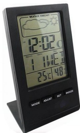
Рис. 1.1. Багатофункціональний цифровий модуль Hanksares, що поєднує в собі систему точного часу з будильником та комплексні датчики для моніторингу атмосферного тиску, температури й відносної вологості повітря
