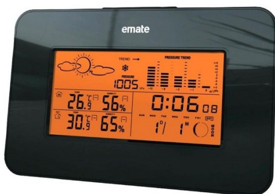
Рис. 1.2. Комбінована цифрова метеостанція з інтегрованими модулями барометрії, термометрії та гігрометрії. Пристрій забезпечує одночасну візуалізацію поточного часу та ключових параметрів стану навколишнього середовища на єдиному дисплеї
