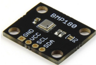
Рис. 3.5. Модуль з датчиком BMP180 фірми Bosch Sensortec GmbH
