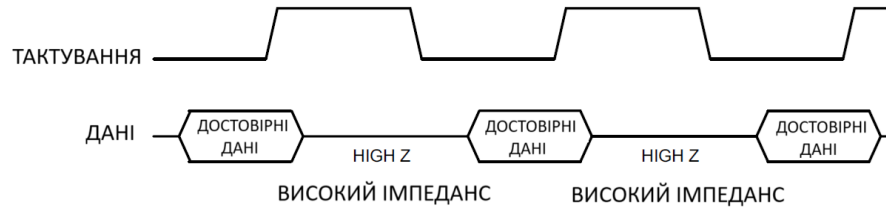
Рис. 1.14. Часова діаграма формування вихідних аудіоданих MEMS-сенсора для лівого каналу (Left Channel)
