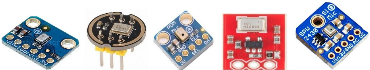
Рис. 1.8. Зовнішній вигляд популярних модулів I2S MEMS-мікрофонів: від серії SPH0645LM4H до компактних рішень типу SPW2430
