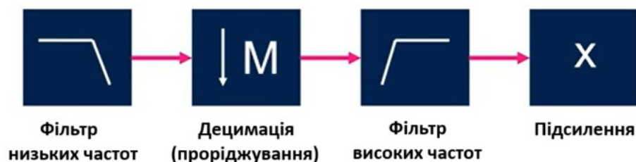
Рис. 3.2. Графічне представлення етапів фільтрації та децимації PDM-сигналу
