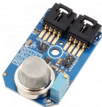
Рис. 3.14. Модуль газоаналізатора серії MQ з інтегрованою підтримкою цифрового протоколу передачі даних
