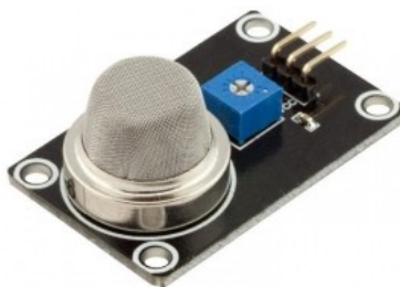
Рис. 3.12. Модуль датчика MQ, адаптований для підключення до АЦП
