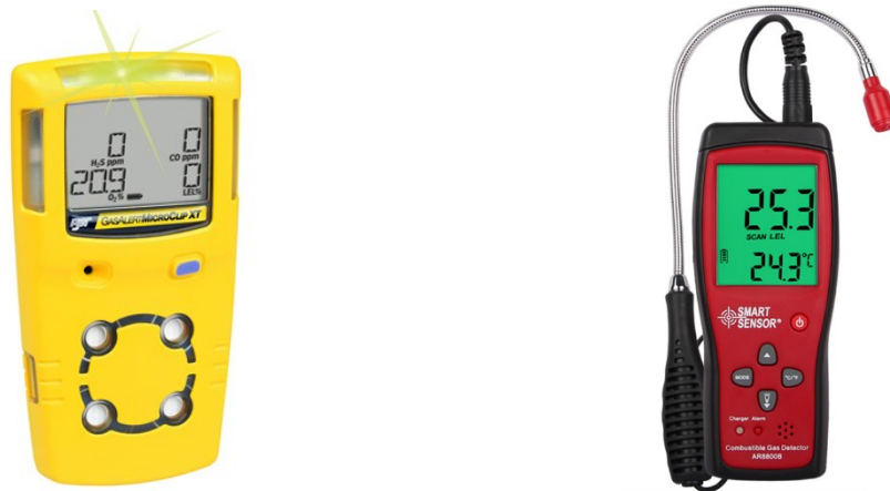
Рис. 1.7. Промислові портативні газоаналізатори: а) багатоконпонентний детектор BW GasAlertMicroClip XT; б) детектор витоку горючих газів Smart Sensor AR8800B
