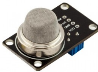
Рис. 3.13. Вимірювальний модуль серії MQ з комбінованим (аналоговим та цифровим) інтерфейсом
