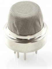
Рис. 3.11. Конструктивне виконання сенсора газу MQ-серії
