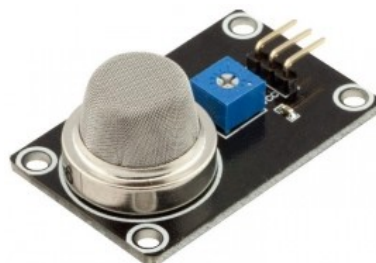
Рис. 3.12. Модульне виконання аналогового сенсора газу серії MQ з інтегрованою обв'язкою
