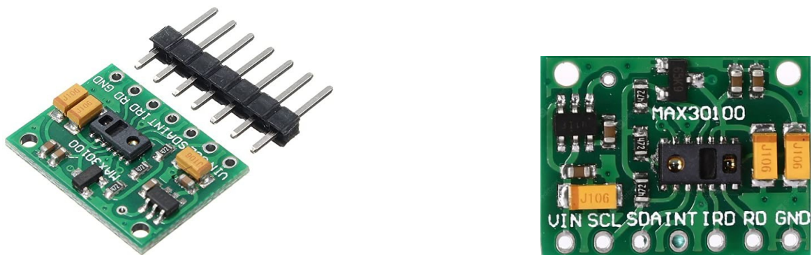
Рис. 3.3. Зовнішній вигляд модуля пульсоксиметра на базі мікросхеми MAX30100
