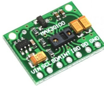
Рис. 1.33. Зовнішній вигляд вимірювального модуля на базі інтегрованого сенсора MAX30100
