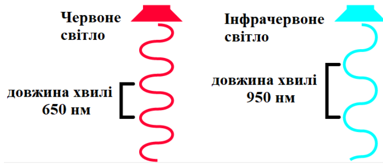
Рис. 1.20. Конфігурація оптичних випромінювачів: світлодіод видимого спектра (650 нм) та інфрачервоний діод (950 нм)
