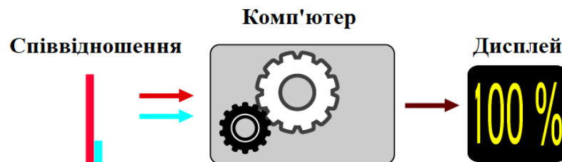
Рис. 1.25. Функціональна залежність рівня сатурації ( SpO_2 ) від розрахованого співвідношення інтенсивностей поглинання червоного та інфрачервоного випромінювання
