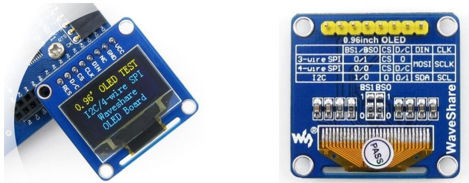
Рис. 3.9. Зовнішній вигляд та конфігурація OLED-модуля з роздільною здатністю 128×64 точок під керуванням драйвера SSD1306
