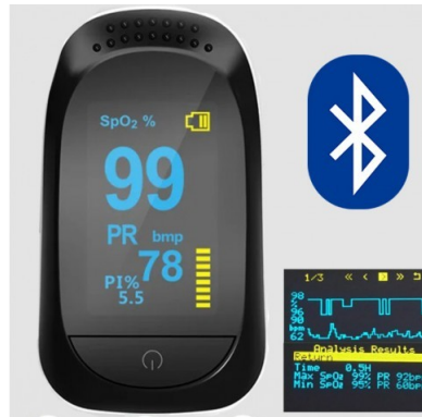
Рис. 1.43. Портативний пульсоксиметр IMDK Medical A2 з інтегрованим модулем Bluetooth для дистанційної передачі даних
